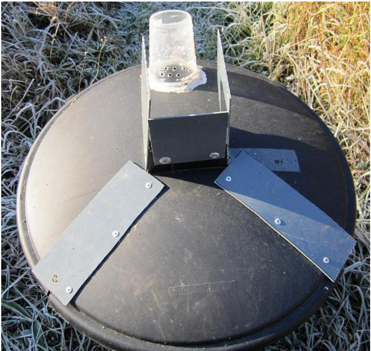
\* Fixer des petits rectangles en plastique sur la poignée centrale avec des rivets ou de la colle, ce qui permettra de tenir la bouteille piège bien en place.
