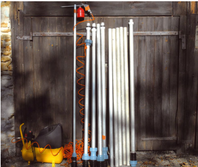
L'ADAAQ a conçu un mât léger permettant d'atteindre les nids situés dans les hauteurs.
